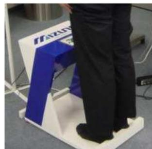
図：足型計測器による計測のイメージ
