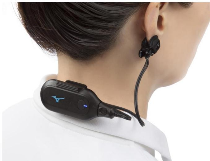
イヤースセンサー式脈拍計「MiKuHa（ミクハ）」プロトタイプ
