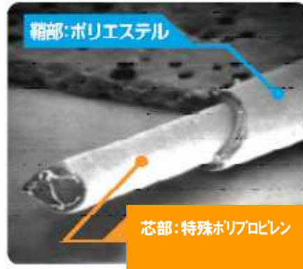
図1 : 『ソーラーカット』の糸断面構造写真
