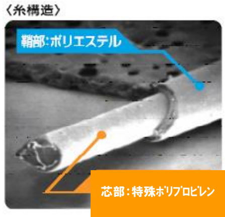
図1：『ミズノ ソーラーカット』の糸断面構造写真
