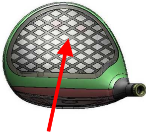
図1：格子状クラウンによる 軽量化(約11g)
