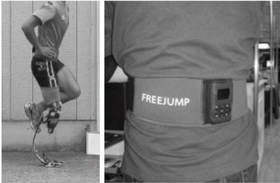
図2. 左: エネルギー蓄積型疾走用足部による片脚ホッピング運動の様子. 被験者はメトロノームで規定されたリズム(2.2 Hz)に合わせて課題を行った. 右: 加速度計は被験者の腰背部にベルトによって装着した.
