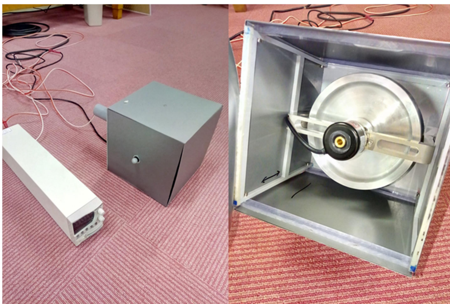
図1. ジャイロ式外乱装置としての錘。左図：錘と DC 電源。右図：樹脂製のカバーの内部にはフライホイールが入っており、これを DC モーターで回転させることにより角運動量を生じさせ、錘を持ち上げる際に回転軸の向きが変化するのに伴い、角運動量保存則に従って新規な姿勢外乱を引き起こす。
